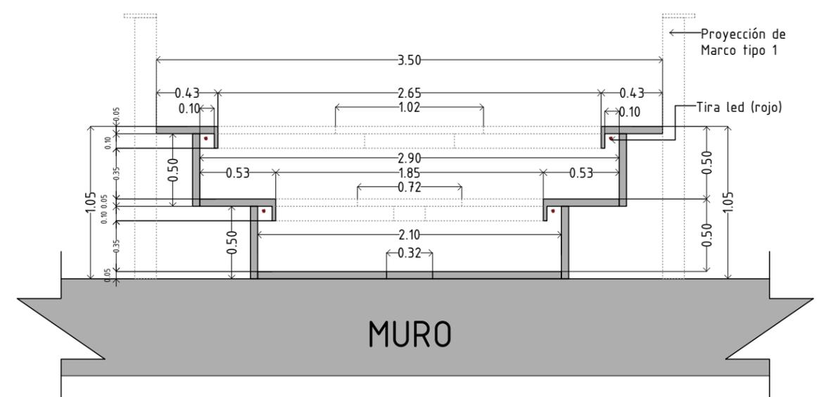
\*Nota: confirmar medidas en sitio, los ángulos del marco museográfico, la altura y el método de sujeción deben de corresponder con la losa de misma forma
